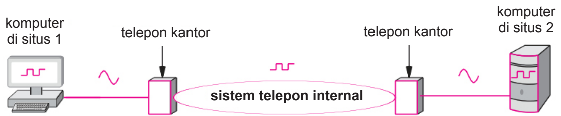
Gambar 10.10 Ilustrasi sinyal digital dan analog (dilambangkan dengan gelombang persegi dan gelombang sinus) yang terjadi ketika modem dialup digunakan untuk mengirim data dari satu komputer ke komputer lain.
