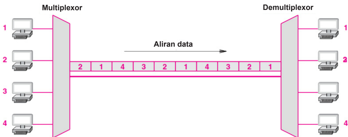
Gambar 11.9 Ilustrasi sistem Synchronous Time Division Multiplexing dengan empat pengirim.
