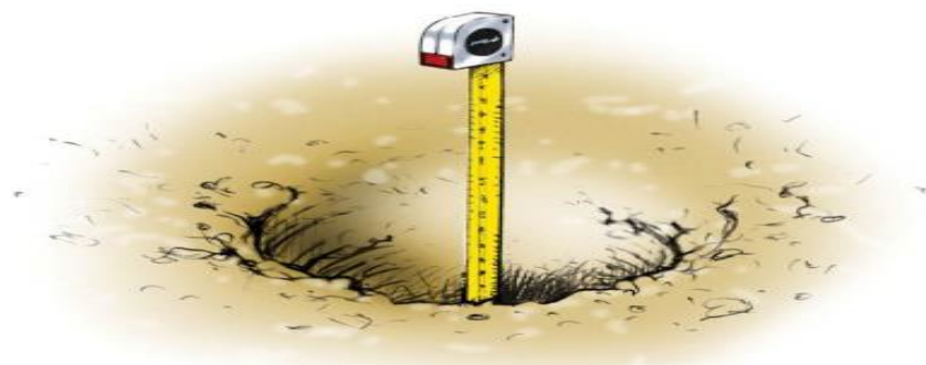
Gambar 7.3 Ambil foto ketika meteran mencuat dari lubang
