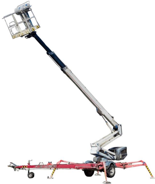
Gambar 5.9 Boom lift adalah penghemat waktu dan kembali yang mungkin tidak lebih mahal daripada perancah.
