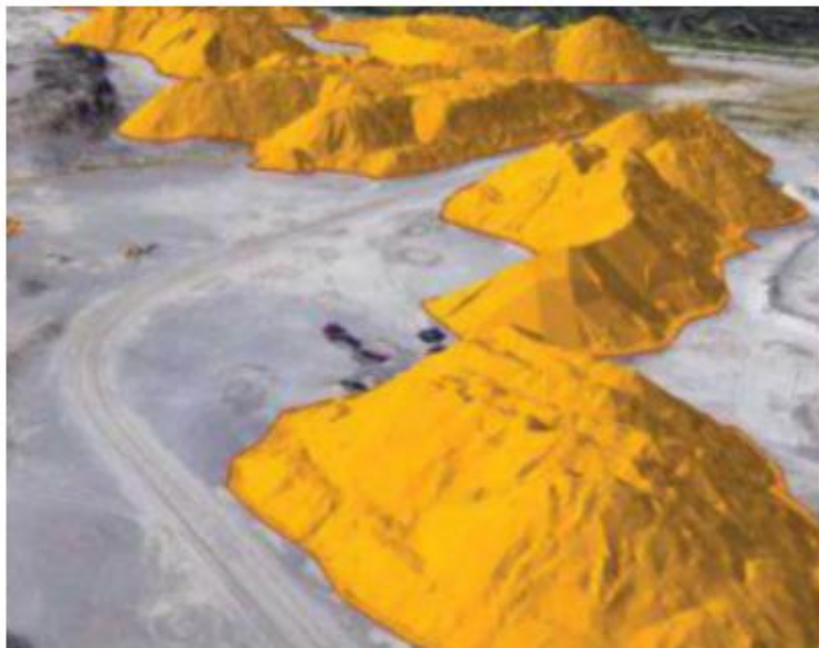
Gambar 2.3 Ini adalah hasil 3D estimasi volume menggunakan drone
