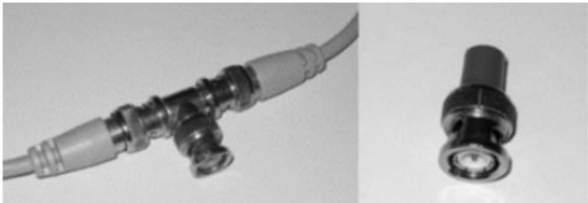
Gambar 4.3 T-connector menghubungkan bus ke NIC dan terminator.
