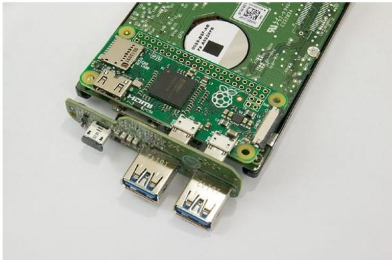
**Gambar 3-17** WDLabs PiDrive Node Zero menggunakan papan anak ini (ditampilkan tanpa memasang perangkat keras) untuk terhubung ke data dan port daya Micro-USB Pi Zero dan port USB PiDrive
