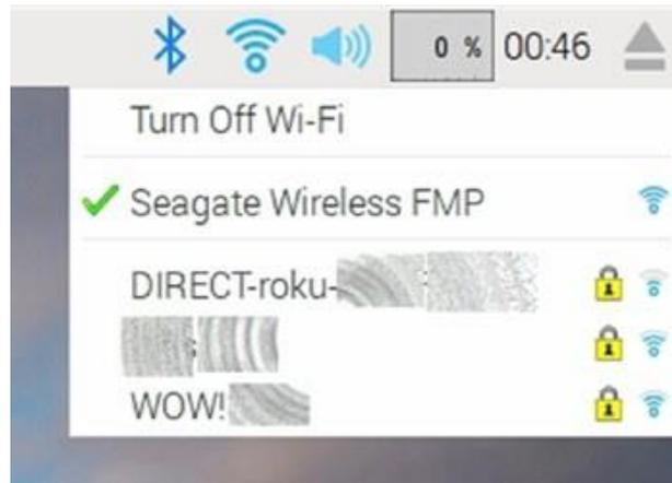
**Gambar 4-8** Menghubungkan ke hard disk Seagate Wireless Plus menggunakan Raspbian dengan manajer koneksi nirkabel PIXEL
