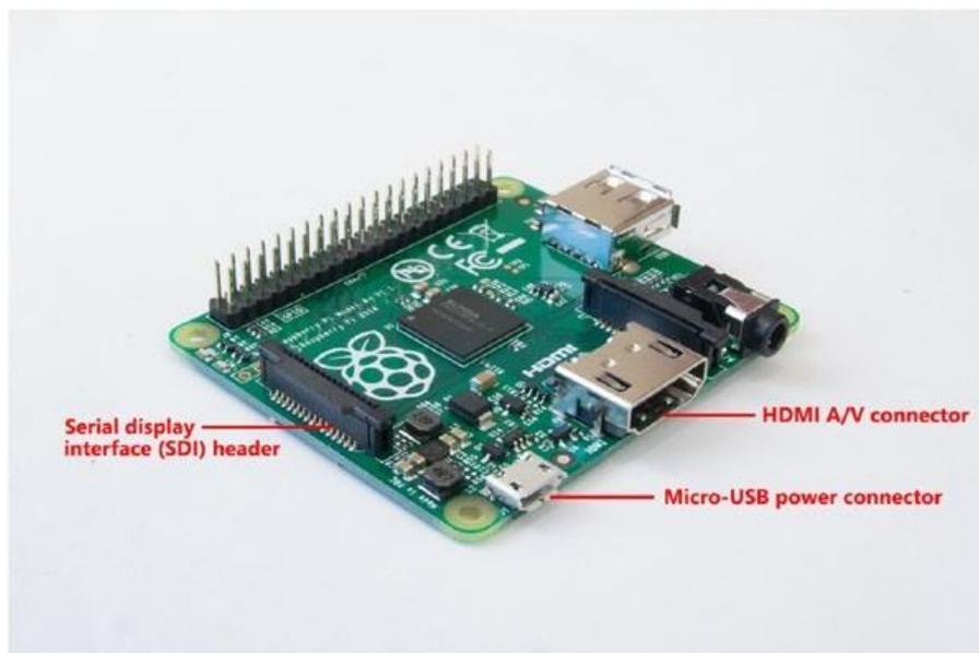
**Gambar 1-4** Serial display interface (SDI) Raspberry Pi Model A+, konektor daya Micro-USB, dan port video HDMI. Slot kartu microSD berada di bawah konektor layar.
