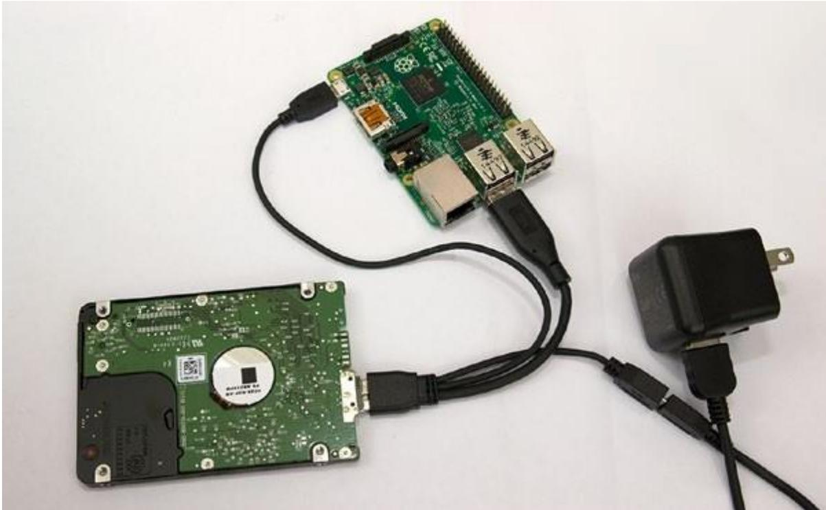
**Gambar 3-16** WDLabs menawarkan catu daya 3A (ditampilkan) dan kabel USB yang menyediakan banyak daya untuk menjalankan PiDrive dan papan Raspberry Pi ukuran penuh atau lebih kecil melalui kabel PiDrive khusus
