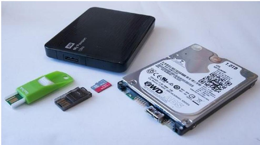
**Gambar 3-1** USB flash drive, pembaca kartu, kartu microSD, hard disk eksternal USB, dan WDLabs PiDrive
