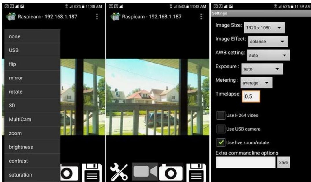
**Gambar 7-14** Menu pemotretan RaspicAM (tengah), menu persiapan (kiri), dan menu pengaturan gambar (kanan). Ketuk ikon floppy disc untuk merekam video atau mengambil foto.
