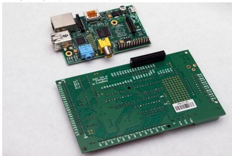
**Gambar 9-3** Konektor Gertboard dibandingkan dengan pin GPIO pada Raspberry Pi Model B
