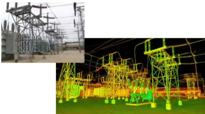
Gambar 15.9 Sebuah foto (kiri atas) dan kumpulan data LiDAR tiga dimensi, merekam koordinat yang tepat pada resolusi yang sangat tinggi. Data koordinat ini berguna untuk inspeksi, rekayasa, dan pemeliharaan, dan biasanya tidak tersedia, atau cukup mahal, sebelum LiDAR (courtesy Landpoint).
