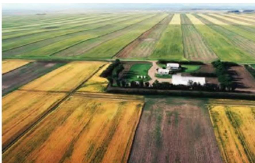
Gambar 6.13 : Contoh konvergensi kemiringan. Pita potong dengan lebar yang sama tampak lebih sempit ke arah cakrawala pada gambar yang sangat miring ini (milik USDA).
