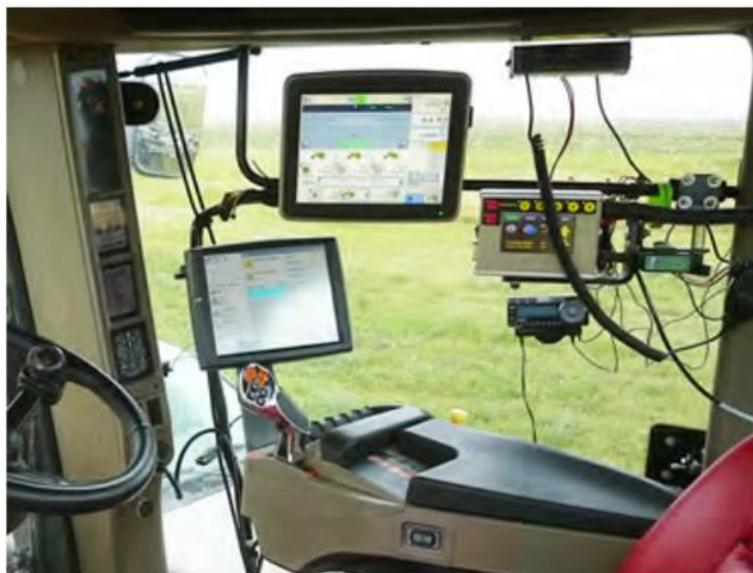
Gambar 5.20: Fitur garis dapat didigitalkan melalui GPS, seperti dalam contoh sistem GIS/GPS yang dipasang di traktor. Tampilan data dan perangkat lunak digitalisasi digunakan untuk merekam koordinat yang dikumpulkan oleh penerima GPS (di atas).
