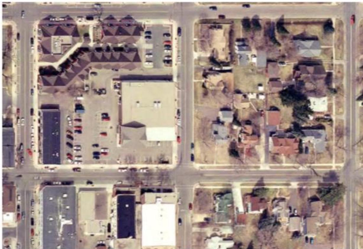
Gambar 6.7: Gambar digital dapat memberikan kualitas gambar yang sama atau lebih baik dari gambar film. Gambar ini menunjukkan gambar yang dikumpulkan pada resolusi 15 cm. Detail ekstrem terlihat, termasuk ventilasi atap, lokasi tepi jalan, dan tiang jalan (milik USGS).
