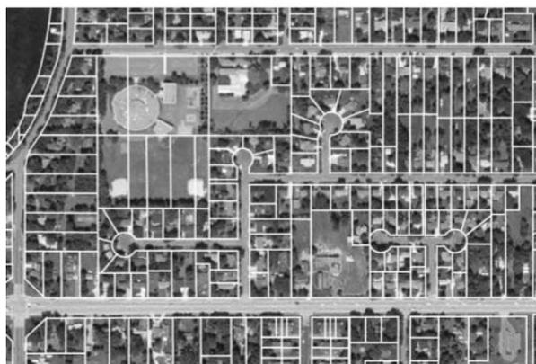
Gambar 5.18: Survei menetapkan koordinat untuk sebagian besar garis properti. Pengukuran lapangan jarak dan arah digunakan untuk menetapkan kumpulan simpul yang mendefinisikan garis batas properti. Ini adalah satu-satunya cara untuk mengumpulkan data ini, karena fitur tidak terlihat di sumber lain.
