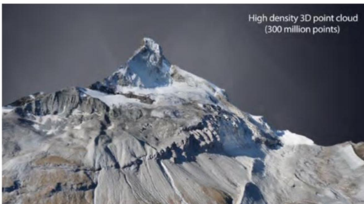
Gambar 6.39 : Kumpulan data tiga dimensi yang direkonstruksi untuk Matterhorn, di Swiss, dikumpulkan dengan UAV. Kepadatan titik dipilih, berdasarkan waktu yang tersedia dan area yang akan diambil sampelnya, dan tidak tetap, seperti pada banyak satelit dan dalam beberapa kasus sistem udara (milik senseFly Ltd.).
