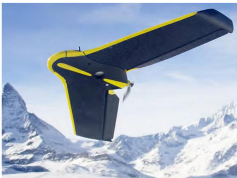
Gambar 6.37: The senseFly ebee, dan contoh UAV kecil / drone yang dioptimalkan untuk pengumpulan data spasial (milik senseFly Ltd.).
