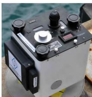
Gambar 3.11 : Alat ukur medan portabel, alat yang digunakan untuk mengukur gaya gravitasi di suatu lokasi medan. Pengukuran ini digabungkan dengan pengukuran survei untuk memperkirakan permukaan geoidal (milik NOAA).
