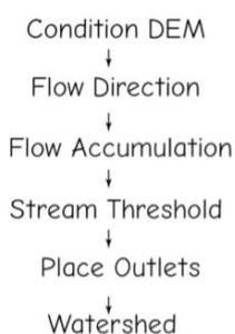
Gambar 11.17 : Langkah-langkah khas dalam delineasi DAS dan sungai.
