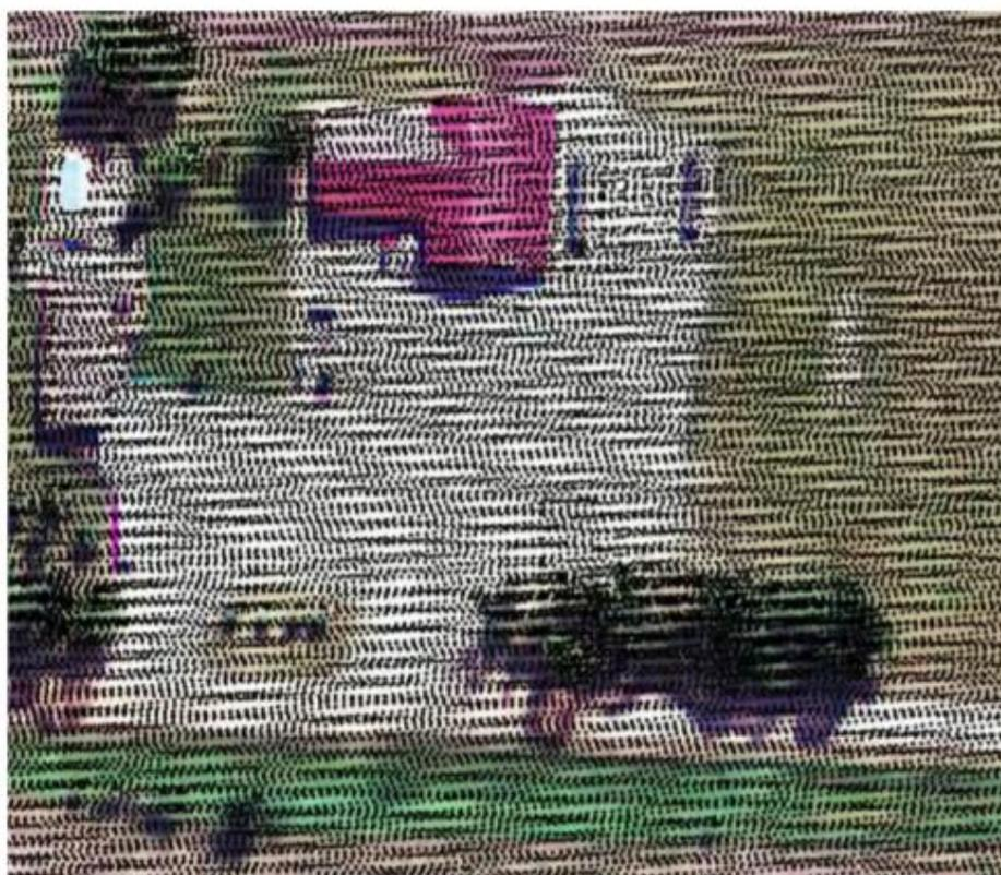
Gambar 6.35 : Pola pengambilan sampel LiDAR, setiap titik mewakili pengembalian lidar. Garis pindai tumpang tindih, menghasilkan distribusi pengembalian yang tidak merata pada skala yang sangat halus. Hasil biasanya diringkas untuk sel raster atau area yang menjangkau celah.
