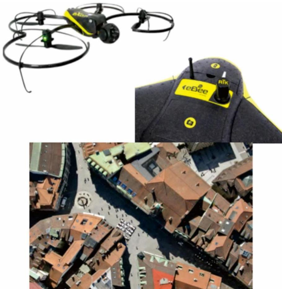
Gambar 15.10 UAV yang dilengkapi dengan kamera dan GNSS canggih dapat mengumpulkan data spasial dengan akurasi milimeter dari citra udara (courtesy senseFly).
