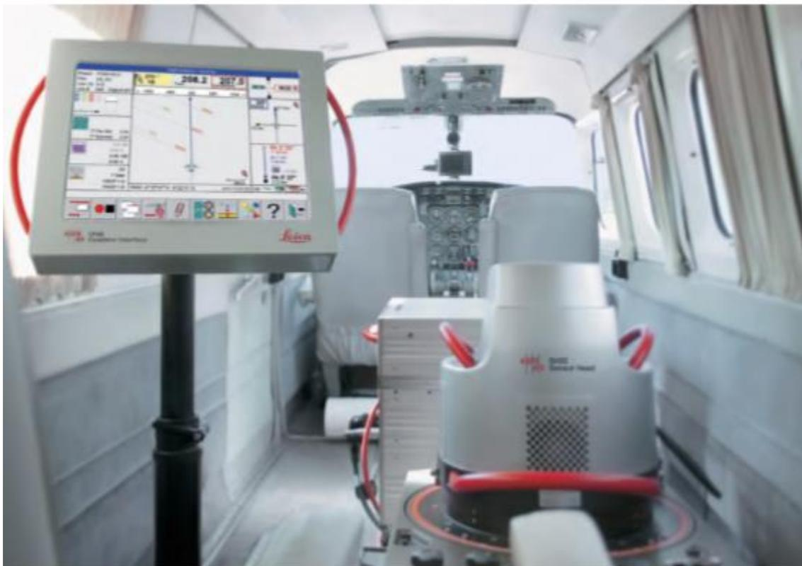
Gambar 6.10 : Contoh sistem canggih (kiri atas) untuk mengontrol pengumpulan gambar digital, di sini dengan kamera udara digital Leica Geosystems ADS40 (kanan bawah). Sistem ini merekam dan menampilkan jalur penerbangan dan stasiun kamera secara real time, dan dapat digunakan untuk merencanakan, melaksanakan, dan memantau pengumpulan data gambar (atas izin Leica Geosystems).
