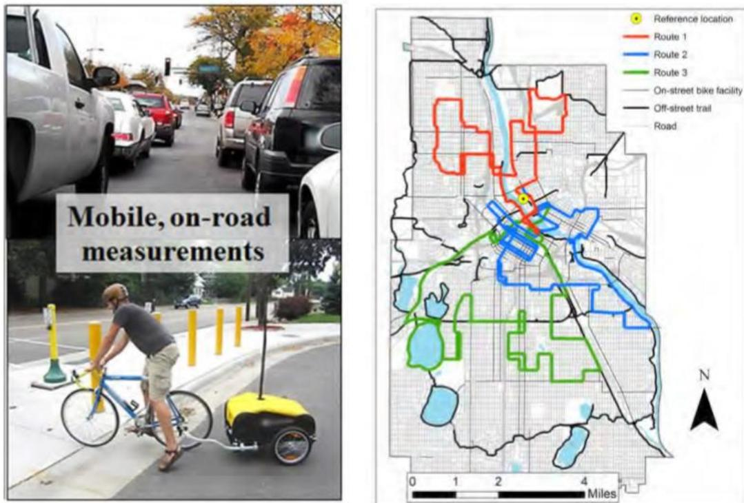
Gambar 1.16: Sampel handuk membantu mengukur polusi udara untuk jalan individu, pada berbagai kepadatan dan jenis lalu lintas (milik J. Marshall).
