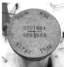
Gambar 3.37 : Sudut PLSS yang telah disurvei dan ditandai dengan tugu. Tugu ini menunjukkan letak fisik suatu ruas sudut. Titik-titik ini sering digunakan sebagai titik kontrol untuk pengembangan data spasial selanjutnya.
