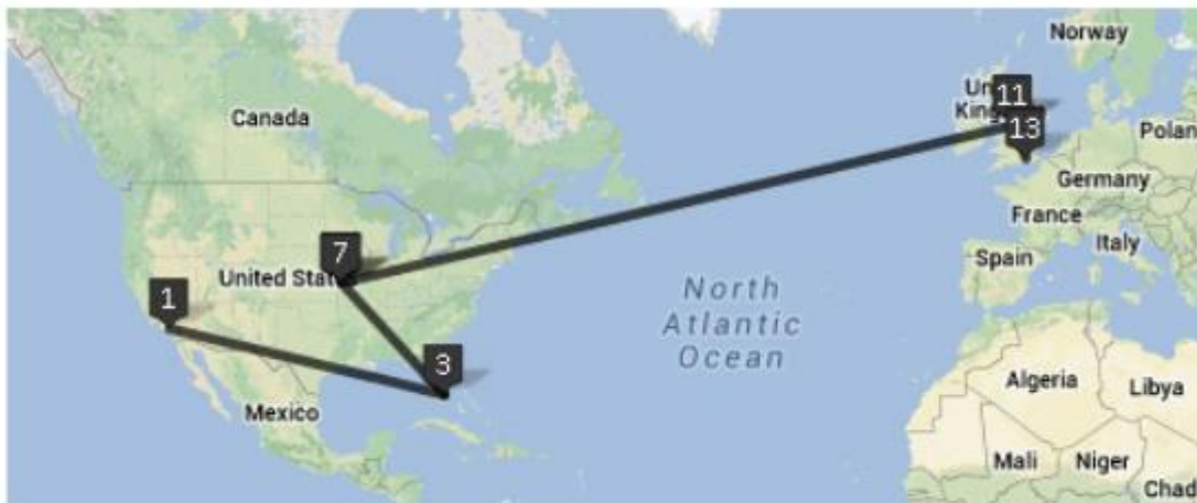
Gambar 8.2 Traceroute visual dari Los Angeles ke London menempuh jarak 7.904 mil dalam 4,8 detik. Di atas adalah contoh jarak dan waktu yang dibutuhkan antara server Web di Los Angeles dan situs BBC di London.
