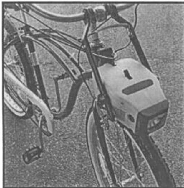
Gambar 1.9 Kit sepeda ZAP SX, yang ditawarkan oleh ZAP USA, adalah kotak kuning yang berisi lampu depan, baterai, dan motor dengan poros keluaran yang mendorong permukaan luar ban depan sepeda.
