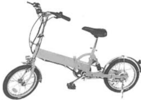
Gambar 1.10 Motor hub di roda belakang mendorong sepeda listrik lipat ZAP World.COM yang dirancang untuk pelancong
