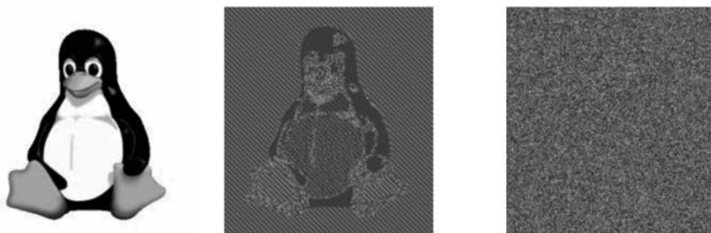
GAMBAR 3.6: Ilustrasi bahaya penggunaan mode ECB. Gambar tengah adalah enkripsi gambar di sebelah kiri menggunakan mode ECB; gambar di sebelah kanan adalah enkripsi gambar yang sama menggunakan mode aman. (Diambil dari http://en.wikipedia.org dan berasal dari gambar yang dibuat oleh Larry Ewing (lewing@isc.tamu.edu) menggunakan The GIMP.)
