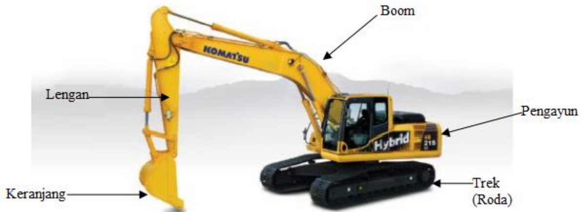
Gambar 6.10 Ekskavator tipikal dengan bagian-bagian yang diberi label. Sumber: Direproduksi dengan Courtesy of Komatsu.
