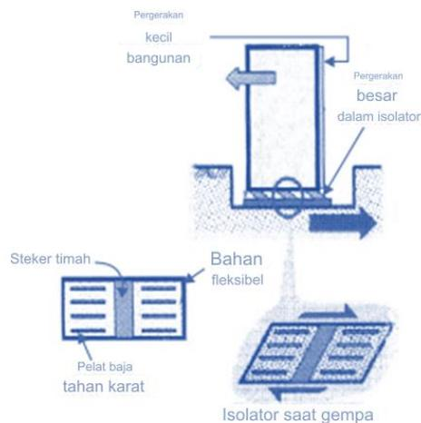
**Gambar 20.4. Bangunan dengan isolasi dasar**
