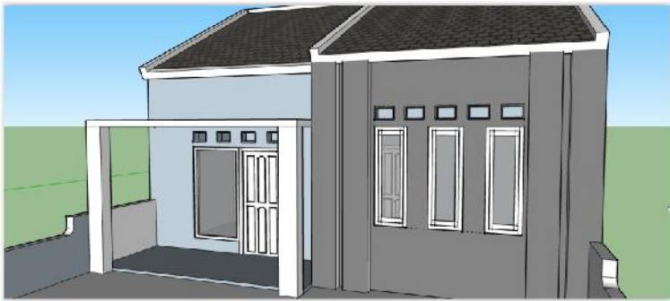
Gambar 5.33 Hasil Pilar pada Fasad rumah dan lubang Ventilasi
