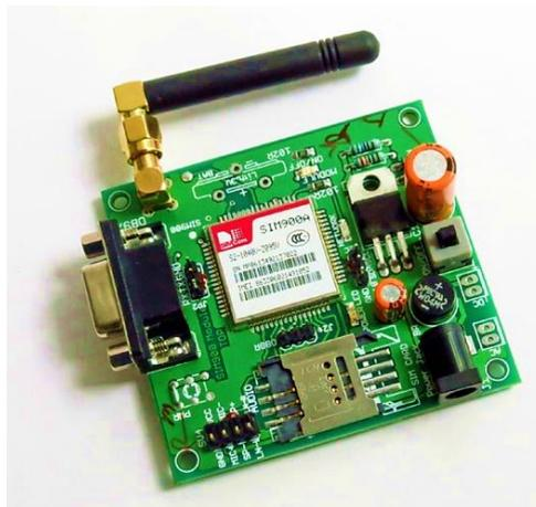
**Gambar 4-4. Modem GSM serikat insinyur Elementz**
