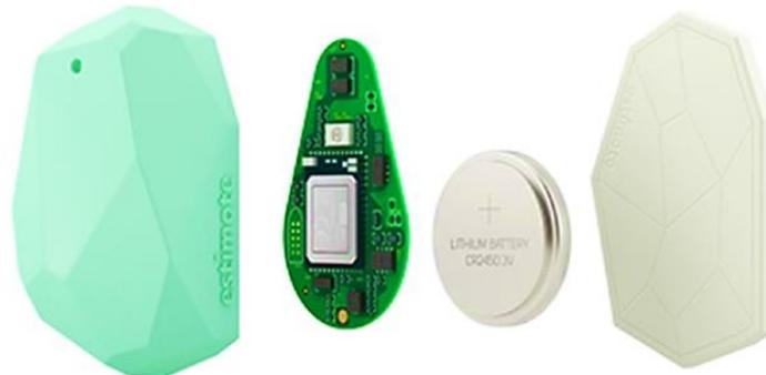
**Gambar 4.9. Suar Bluetooth yang didekonstruksi**
