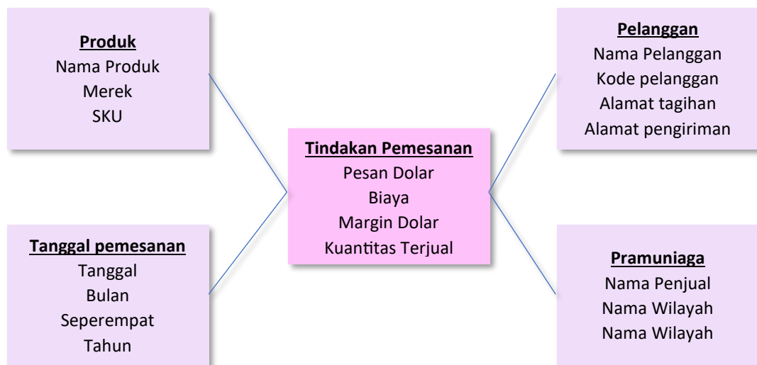
Gambar 10.7 Skema STAR sederhana untuk analisis pesanan.
