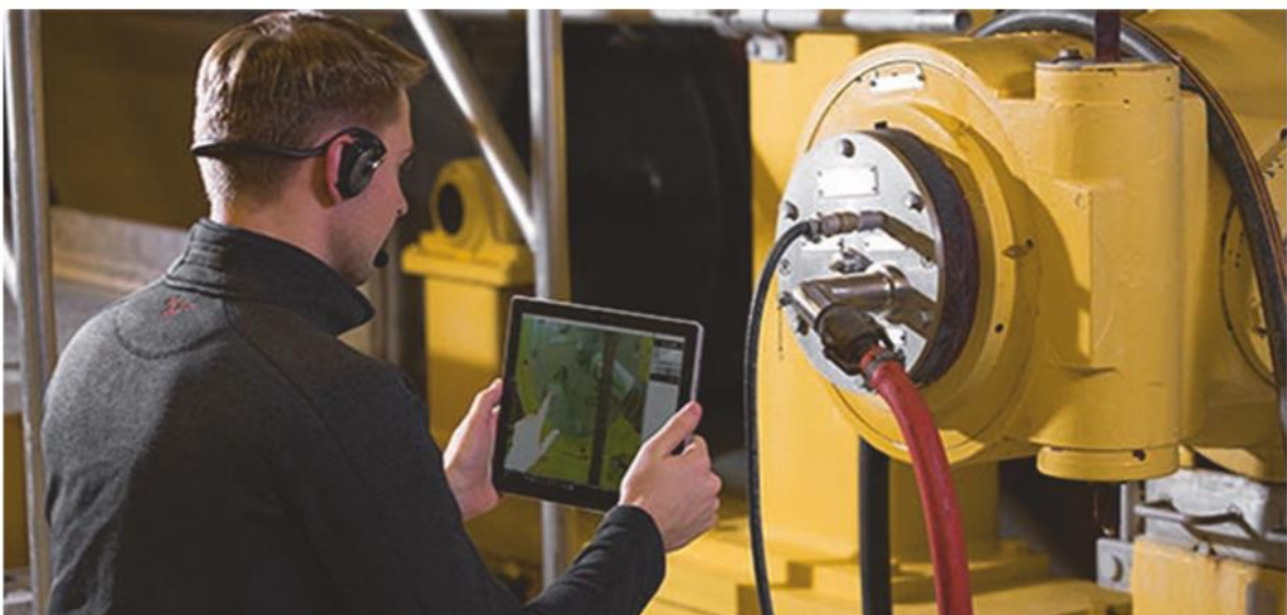
Gambar 3.1 Seorang teknisi dapat menggunakan tablet untuk "melihat" perangkat dan diberikan instruksi tentang cara memperbaiki atau menggunakannya (Sumber: XMReality)
