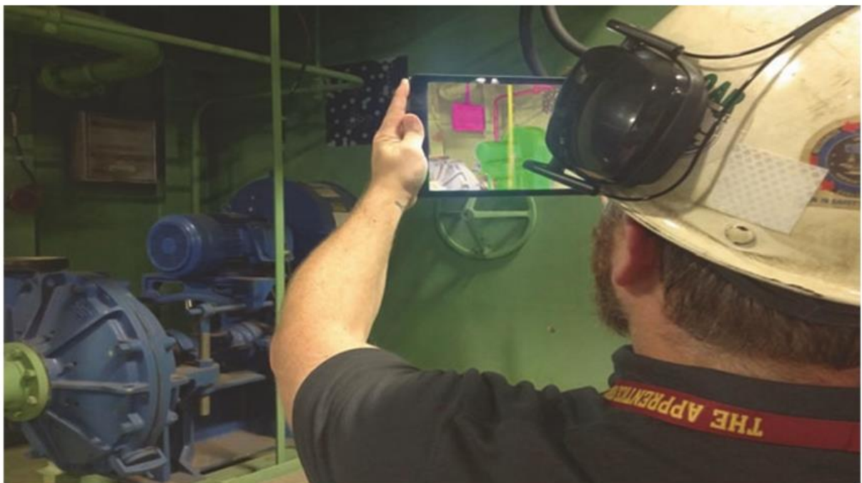
Gambar 6.10 Memvisualisasikan dan merencanakan ke mana pompa dan peralatan baru akan digunakan di kapal induk (Sumber: Huntington Ingalls)
