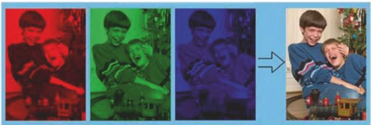
Gambar 8.18 Teknik warna sekuensial bidang (Sumber: Syndiant)
