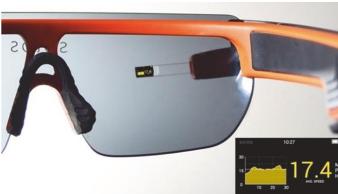
Gambar 8.14 Pupil modul 4 mm Kopin, di belakang rim dan hampir tidak terlihat dari luar (Sumber: Kopin)
