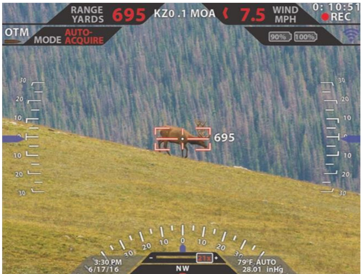
Gambar 6.69 HUD senjata menampilkan target, dan data penting termasuk jangkauan ke target, kecepatan target, sudut tembakan, arah kompas, dan status baterai (TrackingPoint)
