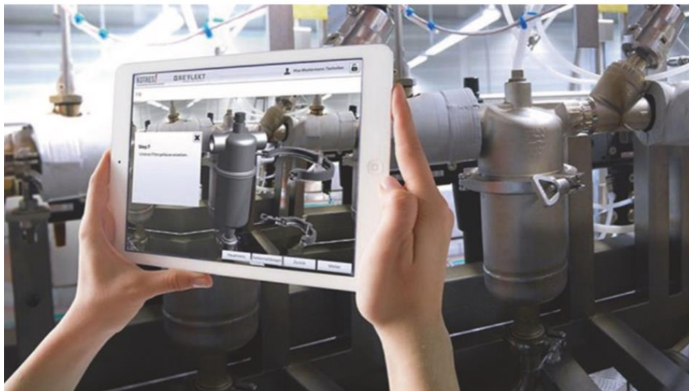
Gambar 6.7 Petunjuk langkah demi langkah untuk mengganti filter uap (Sumber: Kothes/SIG)
