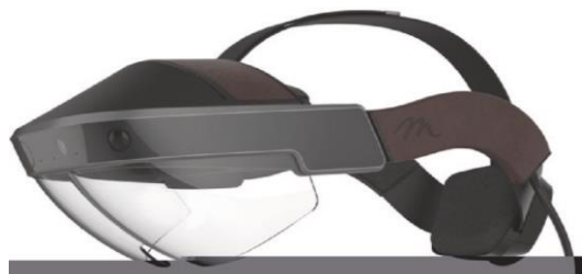
Gambar 8.26 Contoh headset Augmented Reality menggunakan cermin lengkung setengah perak, Meta 2 (Sumber: Meta)
