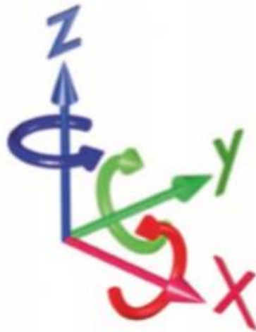
Gambar 8.59 IMU bekerja, sebagian, dengan mendeteksi perubahan x, y, z, pitch, roll, dan yaw (Sumber: Wikipedia)
