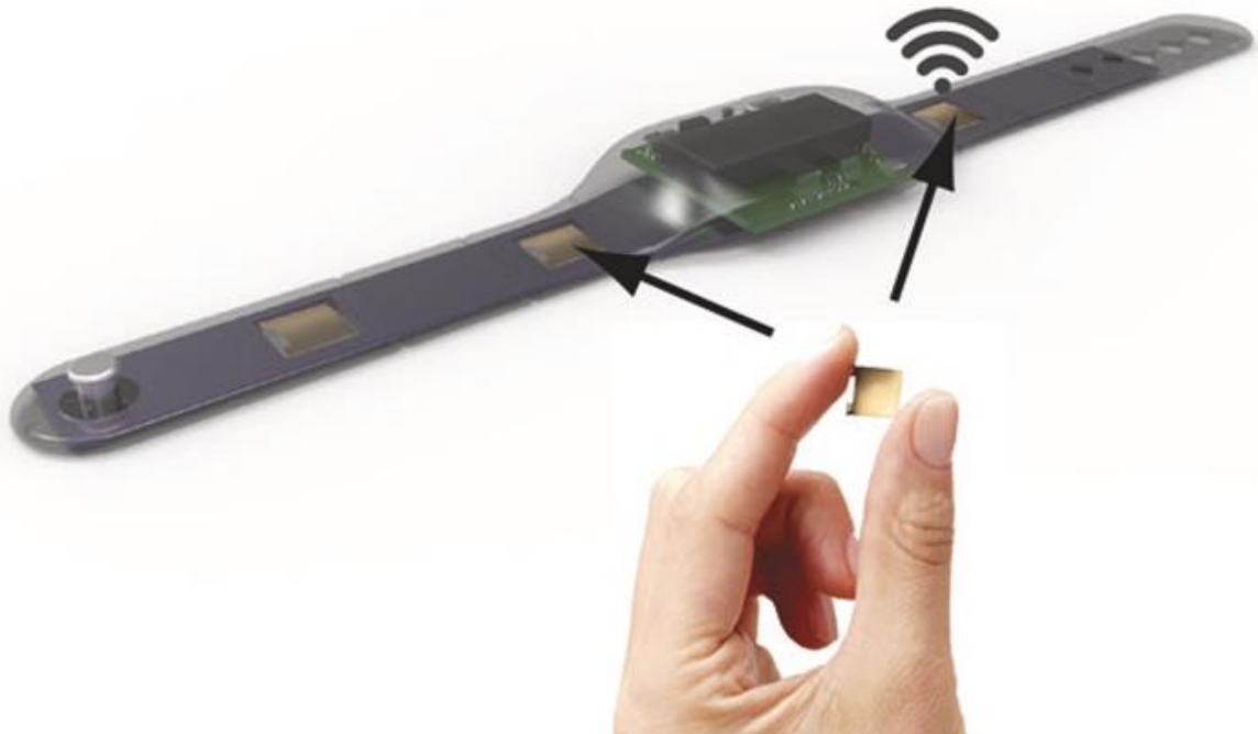
Gambar 8.60 Salah satu implementasi aktuator adalah 10 \times 10 mm dan tebalnya hanya 150 m (Sumber: Novasentis)
