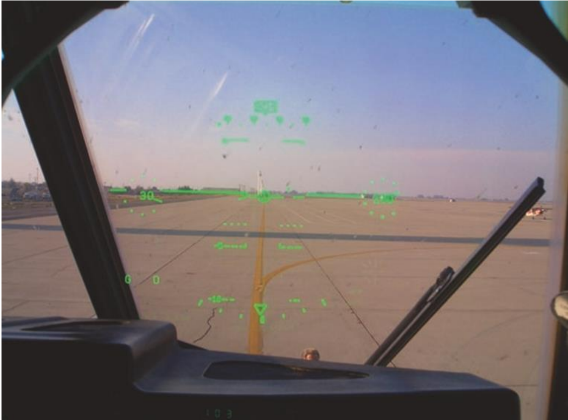
Gambar 6.53 Tampilan head-up kopilot dunia nyata di pesawat C-130J (Wikipedia)
