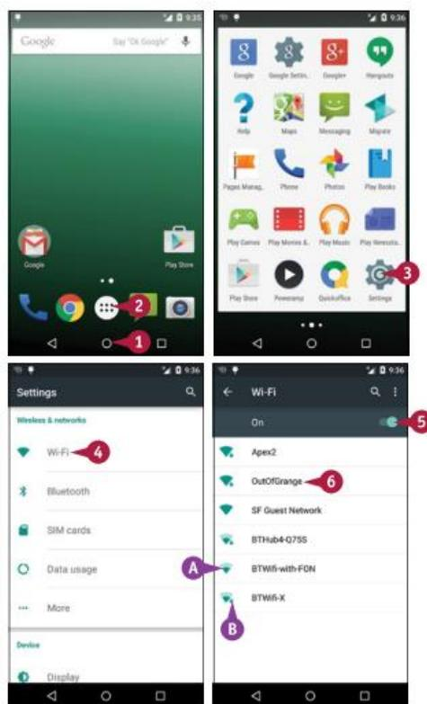
**Gambar 4. 15** Langkah Menghubungkan Ke Jaringan Nirkabel Infrastruktur
