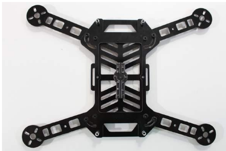
Gambar 3-11 PDB ditekan dengan kuat ke tempatnya.
