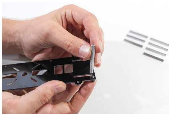
Gambar 2-15 Menghubungkan kebuntuan 37 mm pertama di bagian belakang sekrup pemasangan kami.
