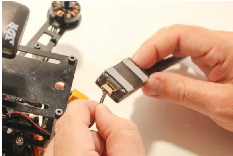
Gambar 7-4 Mencolokkan radio telemetri akan jauh lebih mudah jika dilakukan sebelum dipasang ke bingkai.
