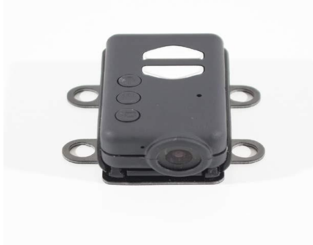
Gambar 12-2 Kamera olahraga aksi Mobius pilihan bagus untuk pesawat seukuran Little Dipper sangat populer karena bobotnya yang ringan dan performanya yang tinggi.
