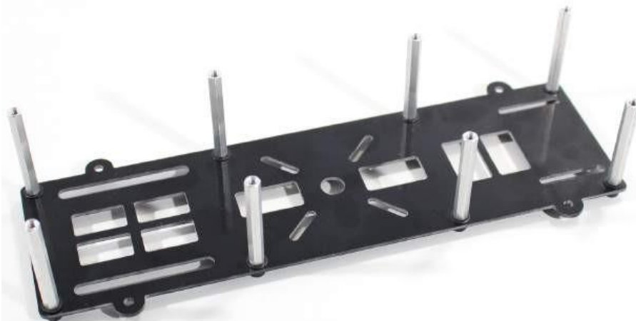
Gambar 2-18 Pelat D dengan semua standoff 37 mm terpasang dan siap untuk pelat E.
