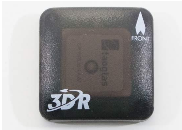
Gambar 5-1 Unit GPS uBlox 3DR dengan kompas bawaan.
