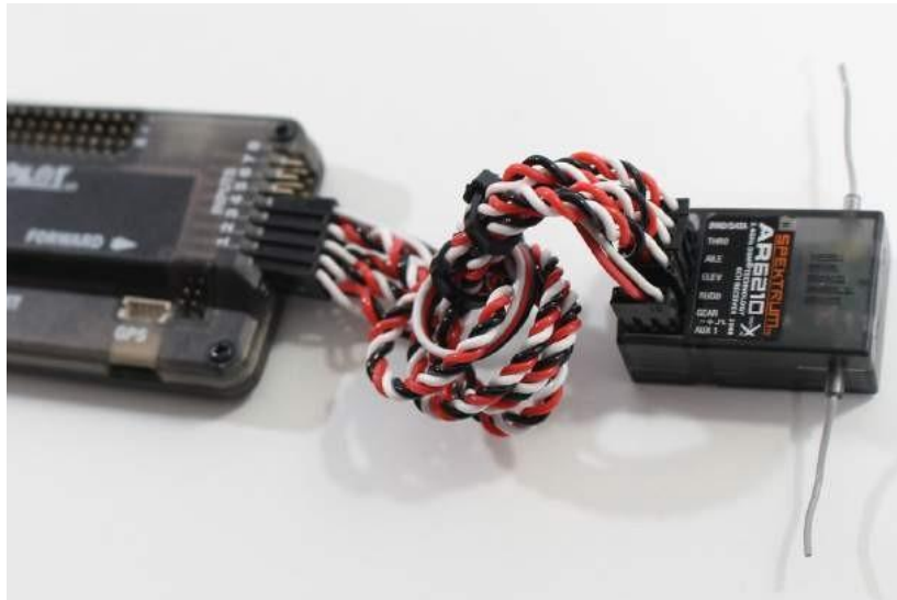
Gambar 6-3 Penerima Spektrum kami dicolokkan ke input APM di bangku.
