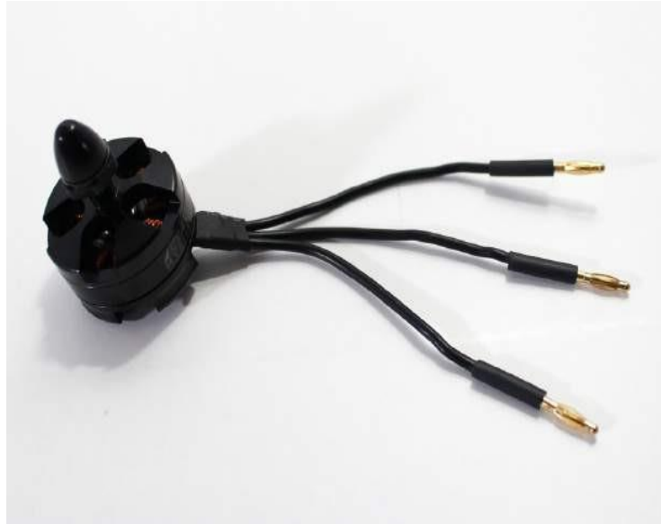
Gambar 3-15 Heat shrink sudah terpasang dan siap untuk menggunakan heat gun.
