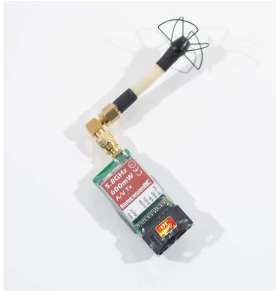
Gambar 8-3 Pemancar video 5,8 GHz dengan antena daun semanggi opsional dan sudut kanan.
