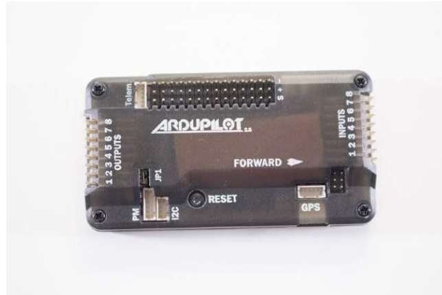
Gambar 4-1 Pengontrol penerbangan ini memiliki IMU dan port internal untuk sensor eksternal.
