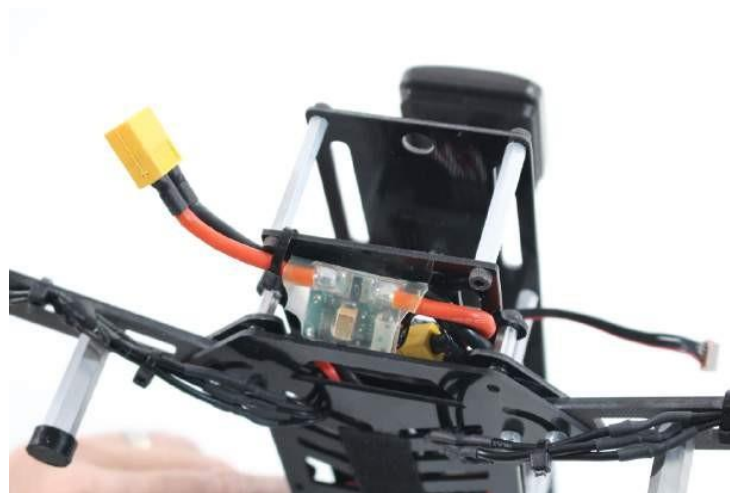
Gambar 5-11 Kabel baterai baru dapat diakses oleh baterai penerbangan.
