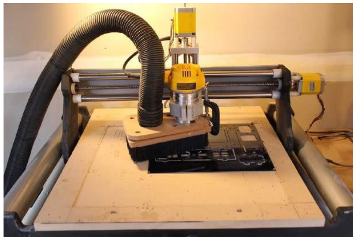
Gambar 2-2 Bingkai fiberglass G-10 sedang dipotong pada mesin CNC.
