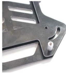
Gambar 2-10 Lubang pemasangan boom belakang (perhatikan lubang jangkar tepat di atas slot lipat).
