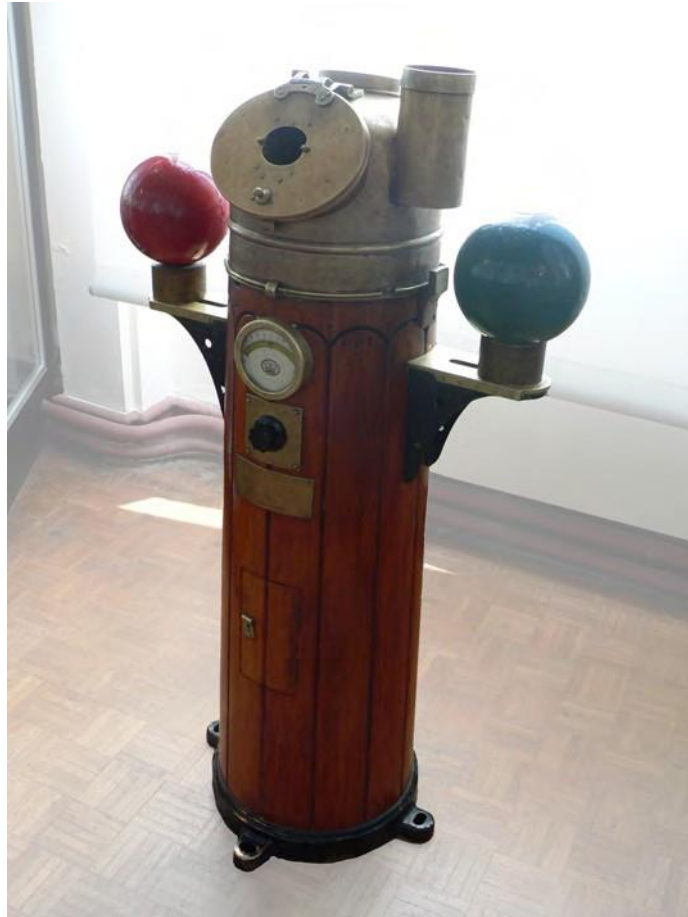
Gambar 19-2 Bola merah dan hijau di binnacle kapal ini benar untuk keberadaan besi di kapal.
