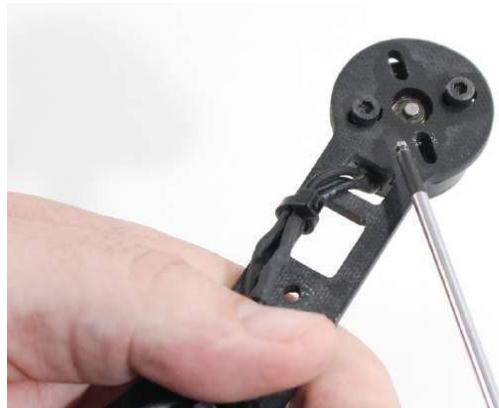
Gambar 3-32 Pasangkan sekrup dengan cara yang sama seperti Anda membuat satu set mur roda pada mobil untuk memastikan kekencangan yang merata di sekelilingnya.
