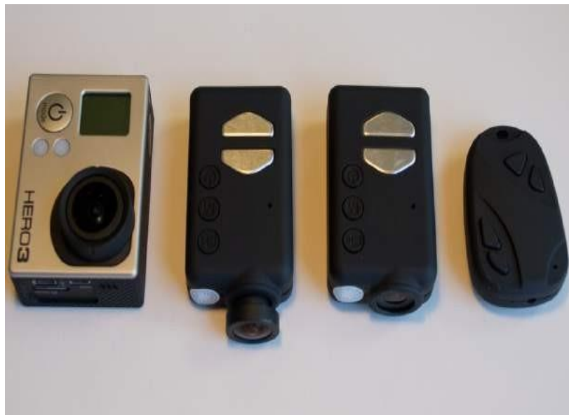
Gambar 8-2 ActionCams berdampingan: GoPro Hero 3, sudut lebar Mobius, lensa standar Modius, dan cam gantungan kunci 808.
