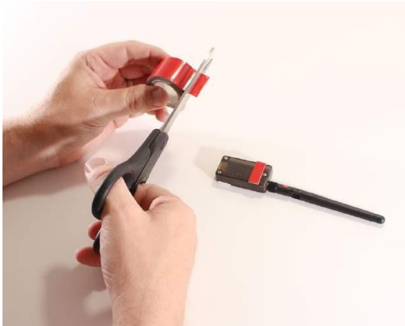
Gambar 7-3 Pita busa dua sisi dapat digunakan untuk mengencangkan radio ke rangka udara.
