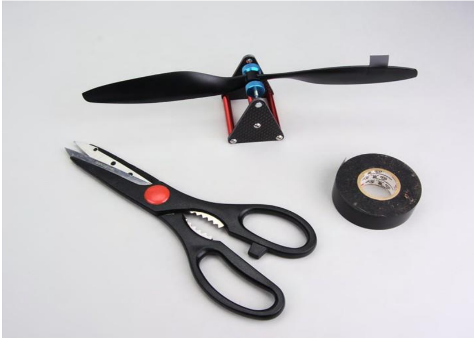
Gambar 21-3 Penyeimbang penyangga, gunting, dan pita listrik adalah semua yang Anda butuhkan untuk menyeimbangkan penyangga.
