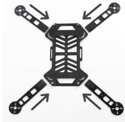
Gambar 2-11 Boom berbaris dan siap diapit di antara pelat rangka kotor atas dan bawah.
