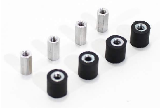
Gambar 2-6 Penyangga—baik aluminium untuk kekakuan dan masa pakai yang lebih lama, atau karet untuk meningkatkan isolasi getaran—digunakan untuk memisahkan kedua subframe.
