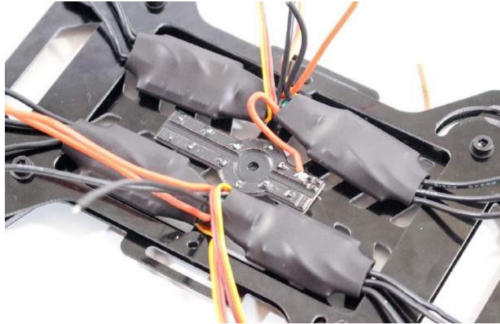
Gambar 3-27 Kabel pertama kami disolder dan tampaknya merupakan sambungan yang solid.
