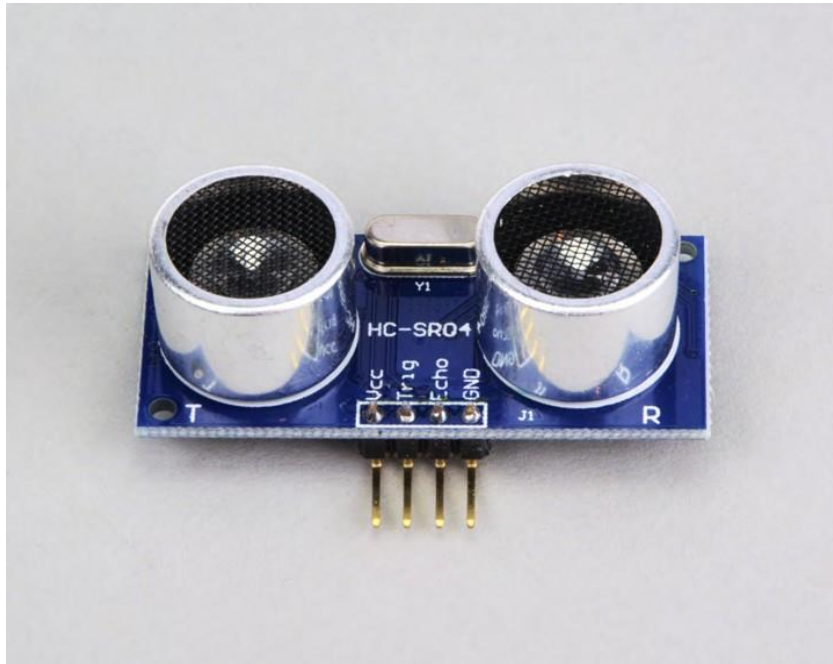
Gambar 20-2 Pinger ultrasonik murah ini dapat digunakan untuk menentukan ketinggian.
