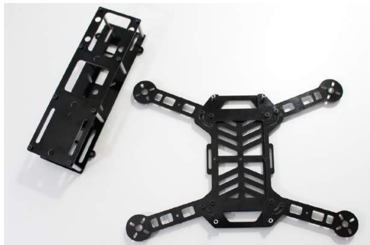
Gambar 2-22 Kedua subframe kami telah dirakit dan siap untuk dimuat dengan komponen penerbangan.
