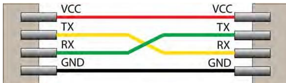
Gambar 23-1 Dalam koneksi serial dasar ini, transmisi masing-masing sisi terhubung ke penerima sisi lain.
