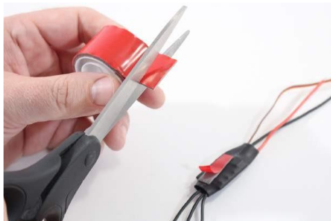
Gambar 3-22 Oleskan strip kecil selotip dua sisi dari sisi uji datar ESC.
