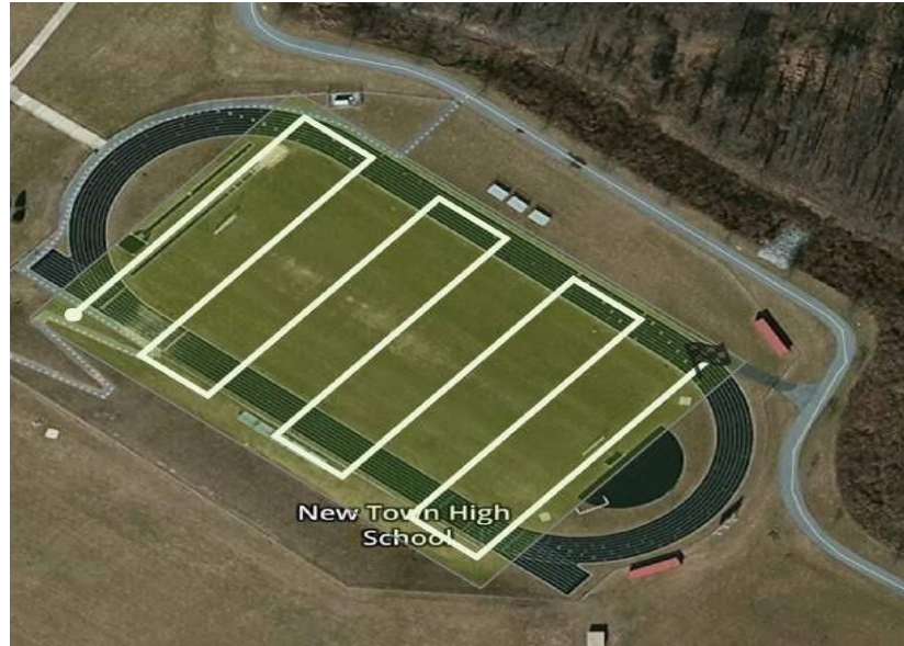
Gambar 11-3 Garis putih menunjukkan jalur penerbangan pemetaan UAV dalam pola mesin pemotong rumput.
