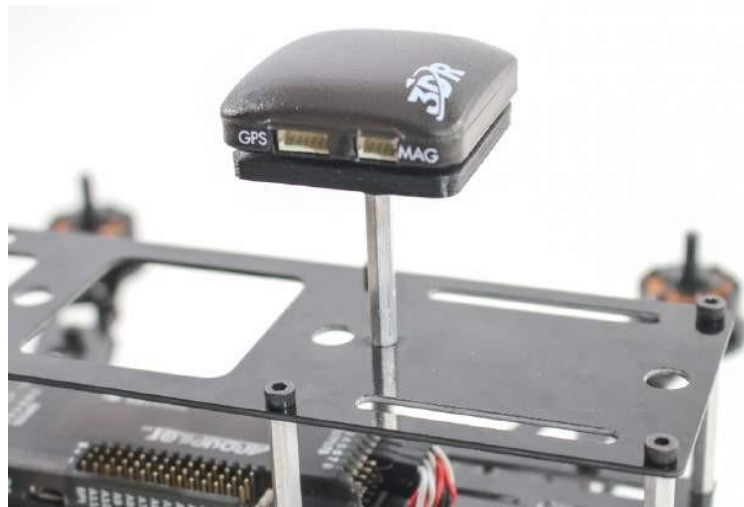
Gambar 5-4 Kami ingin menjaga semuanya tetap sederhana dengan tiang GPS DIY ini.
