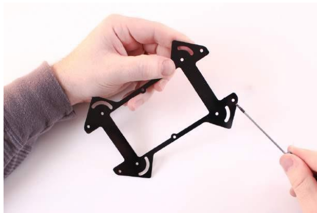
Gambar 2-7 Tunjukkan lubang pemasangan standoff pada pelat B dari rangka yang kotor.
