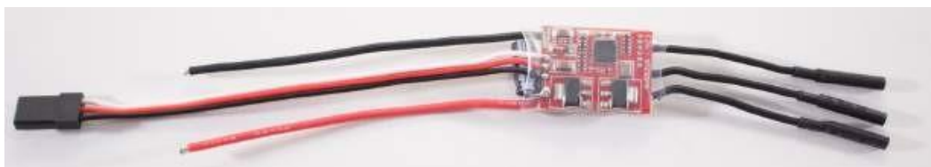
Gambar 3-5 ESC yang kami gunakan dalam contoh build kami diberi peringkat untuk 12 amp dan hingga 16,8 volt (baterai 4S).
