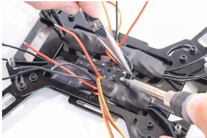
Gambar 3-28 Solder kabel negatif dengan cara yang sama, pastikan Anda menghubungkannya ke sirkuit negatif yang terlihat di sini pada strip yang paling dekat dengan bagian bawah gambar.
