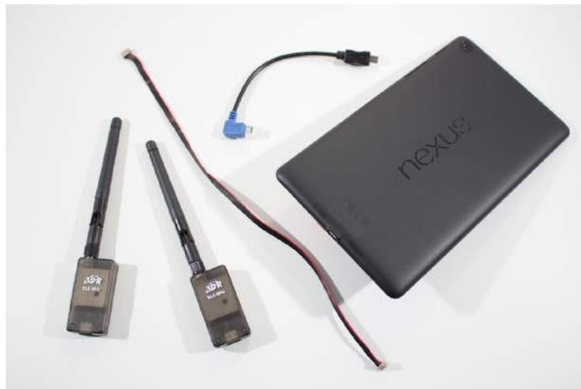
Gambar 7-1 Tablet Android ini dapat digunakan stasiun bumi dengan penambahan radio telemetri dan aplikasi gratis.
