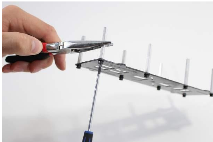
Gambar 2-17 Mengencangkan kebuntuan 37 mm terakhir pada pelat D.
