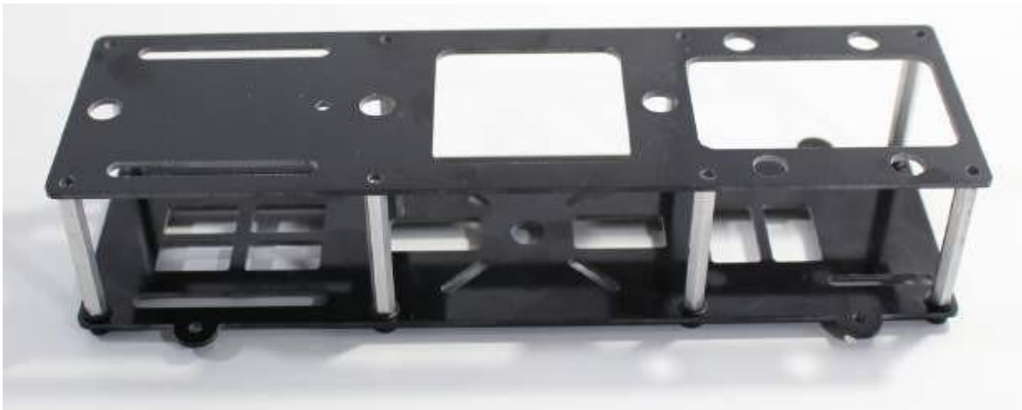
Gambar 2-19 Plat E di atas rakitan kami sebelum menambahkan sekrup pemasangan.
