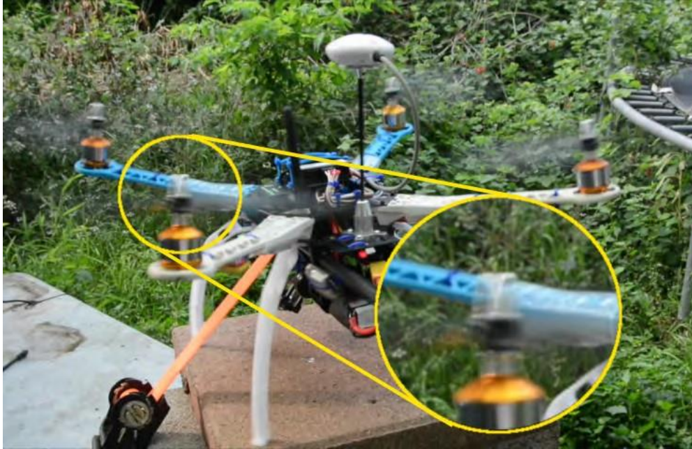
Gambar 21-2 Saat getaran beresonansi dengan bingkai, getarannya bisa menjadi besar.
