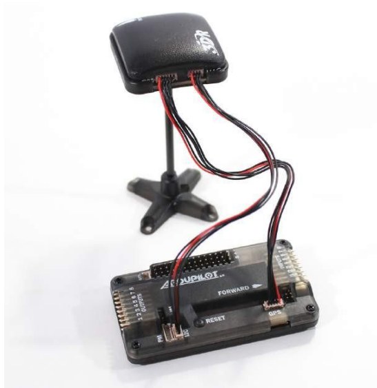
Gambar 5-7 GPS dan kompas (magnetometer) kami dicolokkan ke APM.
