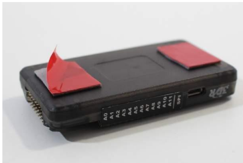
Gambar 4-4 Potong selotip Anda menjadi dua dan letakkan setiap bagian di salah satu ujung APM, lalu lepaskan bagian belakangnya.
