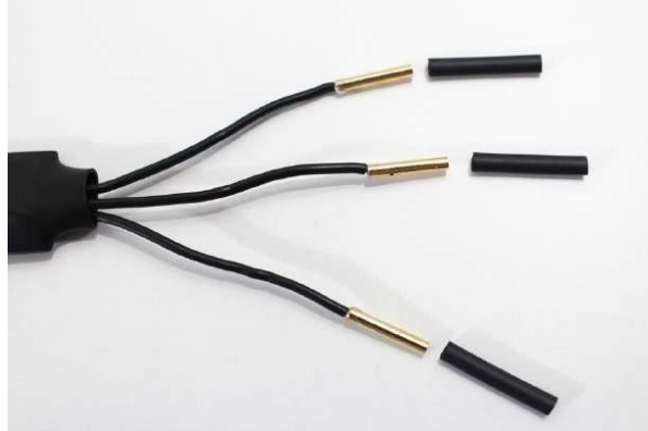
Gambar 3-19 Pastikan untuk memotong panas menyusut ke panjang yang tepat untuk konektor perempuan.
