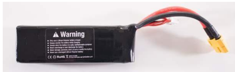
Gambar 3-6 Baterai penerbangan utama tiga sel 2200-mAh.
