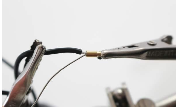
Gambar 3-13 Semuanya dalam posisi dan kami siap untuk menyolder konektor pertama kami.
