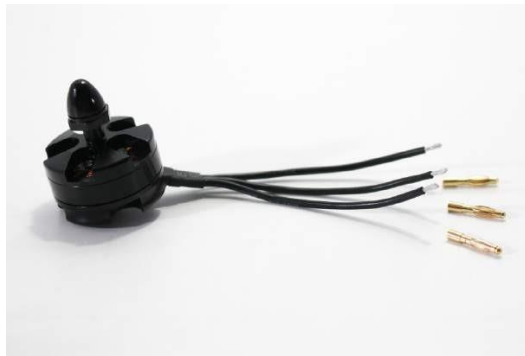
Gambar 3-12 Ujung motor dilucuti, dikalengkan, dan siap untuk mengambil konektor peluru jantan.
