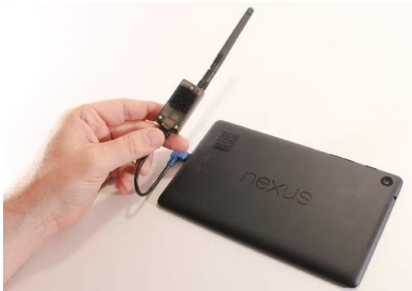
Gambar 7-2 Velcro memegang radio telemetri di bagian belakang tablet kami saat digunakan dan memungkinkan pelepasan yang mudah saat kami tidak terbang.
