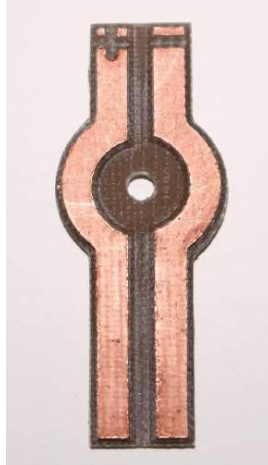
Gambar 3-8 Papan distribusi daya DIY kami dipotong dari G10 berlapis tembaga.
