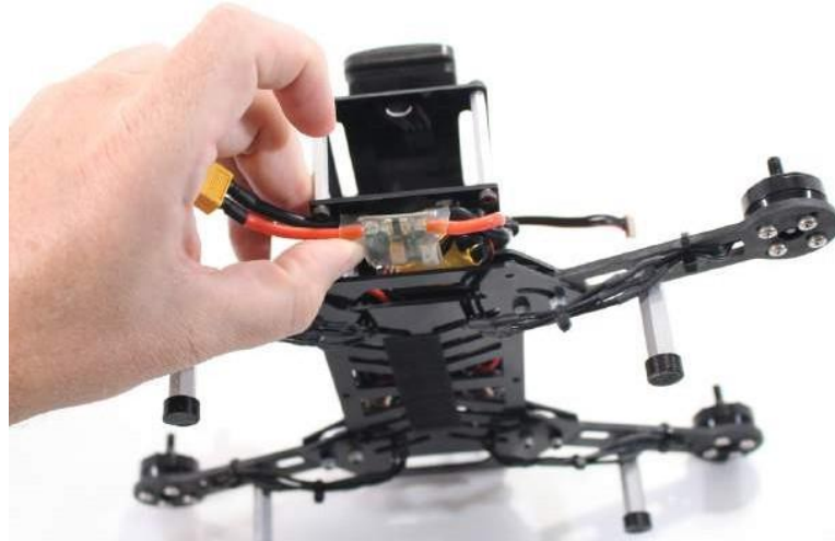
Gambar 5-10 Memasang monitor baterai kami dan siap dipasang ke rangka.
