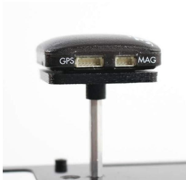
Gambar 5-6 Dua port di samping keping GPS kami.
