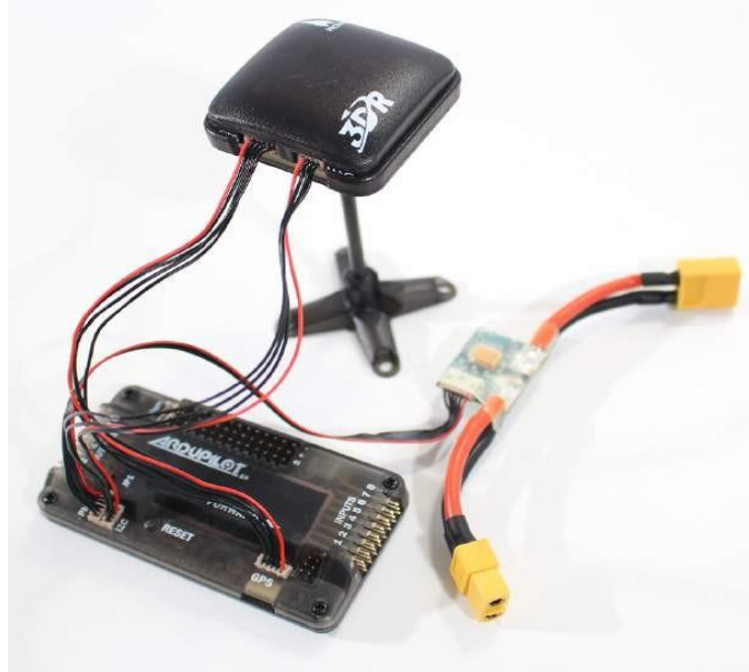
Gambar 5-8 Monitor baterai kami terpasang di bangku, berbicara dengan APM melalui kabel 6 posisi yang dihubungkan ke port PM.
