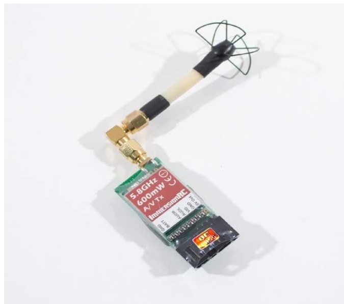
Gambar 12-1 Pemancar video 5,8 GHz dengan adaptor sudut kanan dan antena Skew Planer terbalik.
