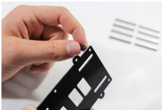
Gambar 2-14 Dorong sekrup 5 mm melalui lubang pemasangan standoff pada pelat D.
