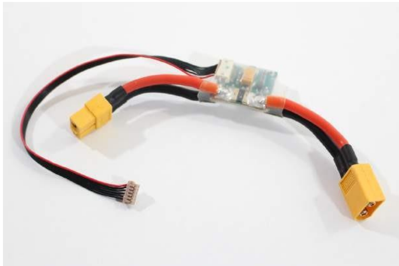
Gambar 5-2 Monitor baterai inline kami mengumpulkan data misi yang sangat penting saat kami terbang.
