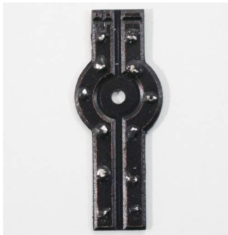
Gambar 3-9 Seperti inilah tampilan PDB kami—kami melapisi beberapa titik solder dan menambahkan selotip cair untuk lapisan insulasi.
