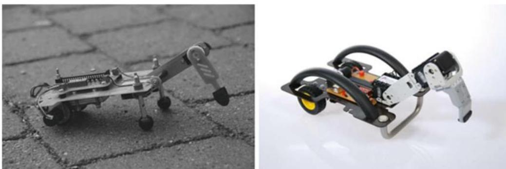
**Gambar 10.10** Dua versi robot perayapan
