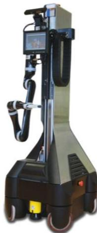
**Gambar 1.4** Robot bantuan Marvin, yang digunakan dalam proyek penelitian AsRoBe
